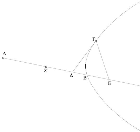
Ἐπεὶ γὰρ ἐφάπτεται ἡ  $\Gamma\Delta$  τῆς τομῆς, καὶ τεταγμένως κατῆκται ἡ  $\Gamma E$ , ἔσται ὡς ἡ  $A\Delta$  πρὸς  $\Delta B$ , ἡ  $AE$  πρὸς  $EB$ .
